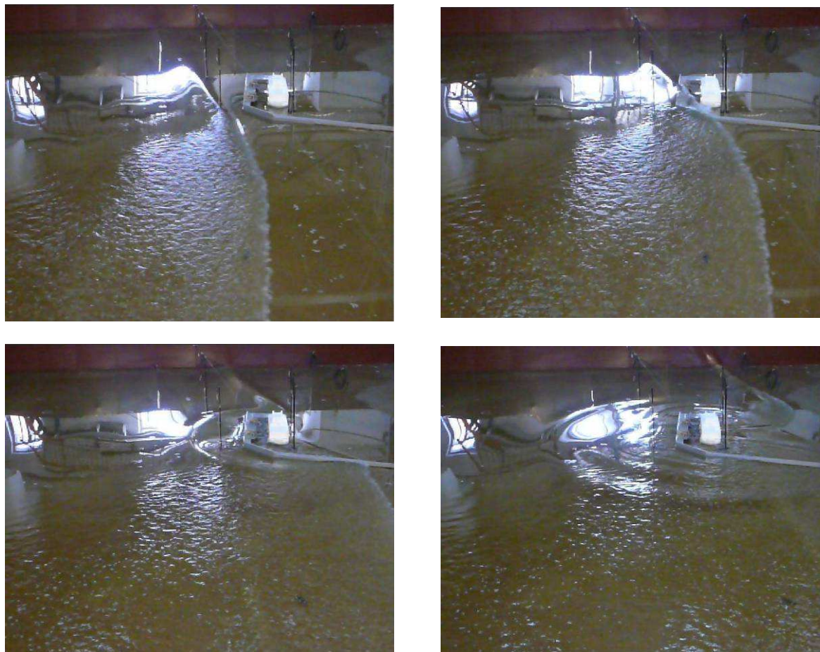
Рис. 3. Модельные испытания ПАТЭС на волну высотой 5.8 м: подход волны; взаимодействие с защитными сооружениями; отражение набегающей волны; остаточные интерференционные явления.
