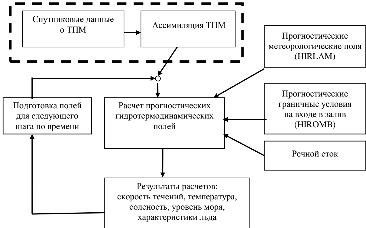
Рис. 1. Оперативная океанографическая прогностическая система для Финского залива GULFOOS. Пунктиром обозначена планируемая, но пока не реализованная часть системы, предназначенная для ассимиляции ТПМ.
