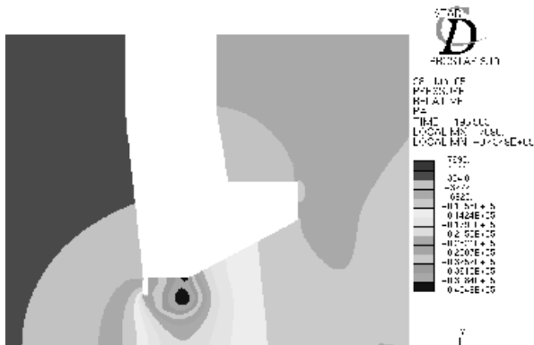
Рис. 9. Форма А, поле давлений при первом законе движения; формирование зоны разрежения при приближении объекта к порогу
