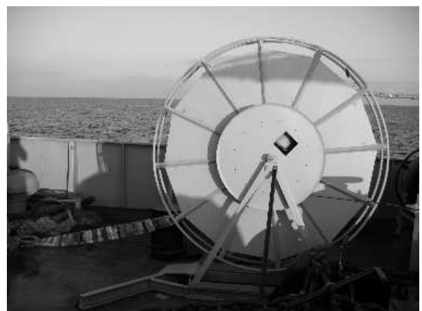
Рис. 3. Внешний вид температурной линии, установленной на судне.
