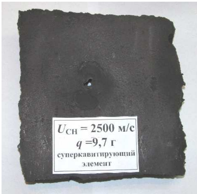
Рис.6. Вид лицевой поверхности бронеплиты после пробития.
