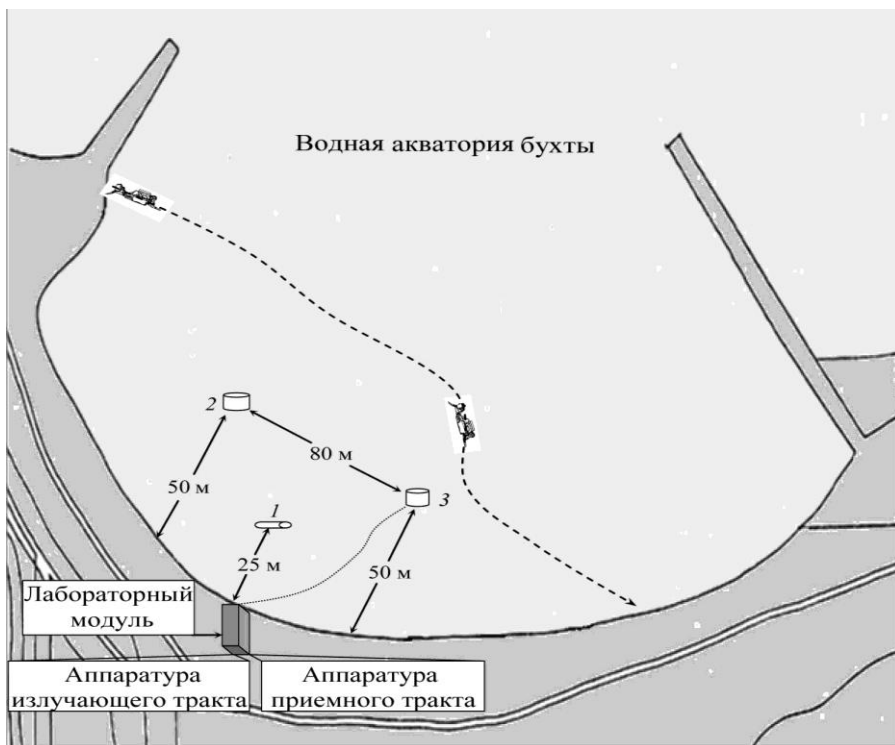
Рис. 6. Схема проведения экспериментальных исследований. 1 — излучатель, 2 — первый приемный гидрофон, 3 — второй приемный гидрофон.
