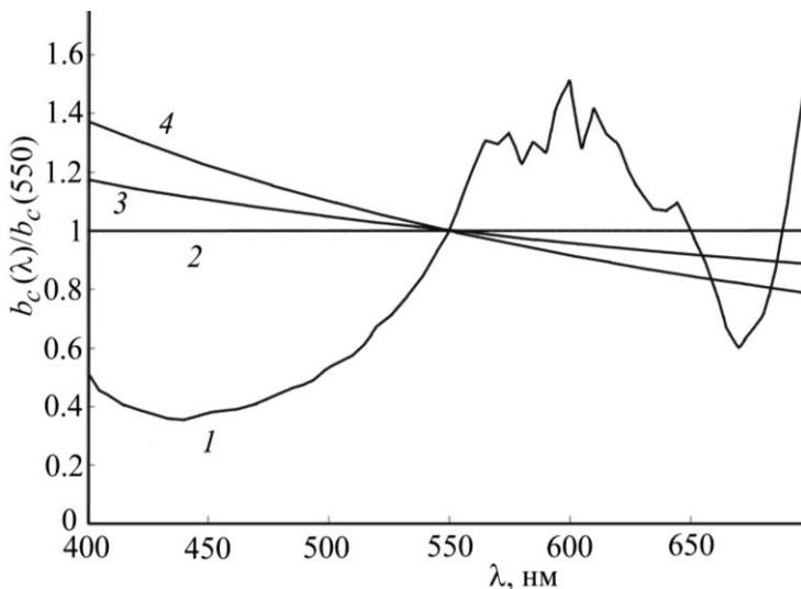
Рис. 10. Зависимость  $b_c(\lambda)/b_c(550)$  от  $\lambda$  по (28) [36, 37] — (1) и по (31) [29, 46] при  $v = 0$  (2),  $-0.5$  (3) и  $-1$  (4).
