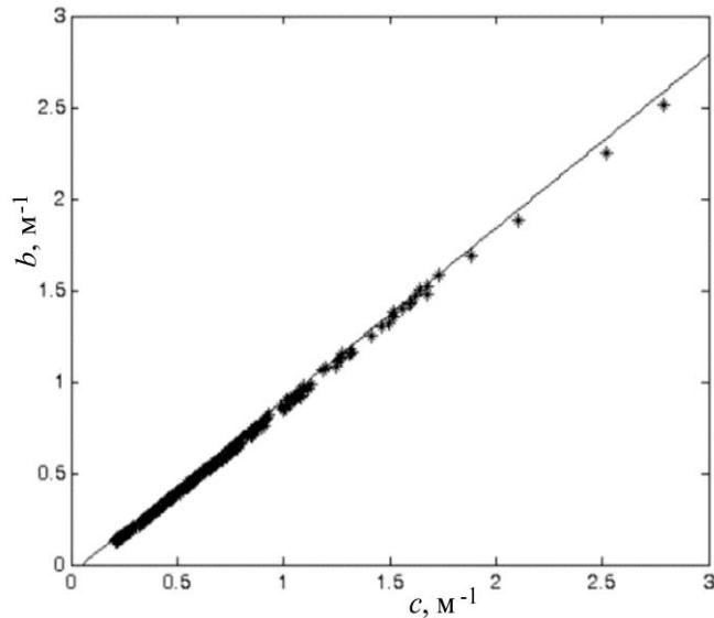
Рис. 5. Зависимость показателя рассеяния от показателя ослабления. Точки — результаты измерения на длине волны 555 нм в Балтийском море, прямая — зависимость (6) ( $\lambda = 550 \text{ нм}$ ).
