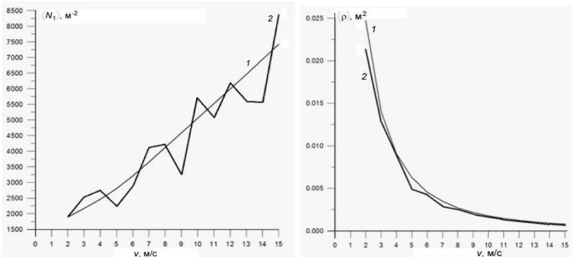
Рис. 3. Зависимости плотности числа зеркальных точек  $\langle N_1 \rangle$  и величины  $\langle \rho \rangle$  от скорости ветра  $v$ .
