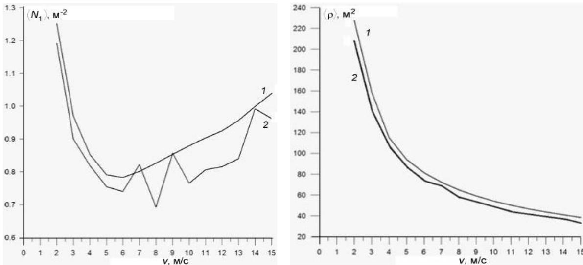
Рис. 6. Зависимости плотности числа зеркальных точек  $\langle N_1 \rangle$  и величины  $\langle \rho \rangle$  от скорости ветра  $v$ .
