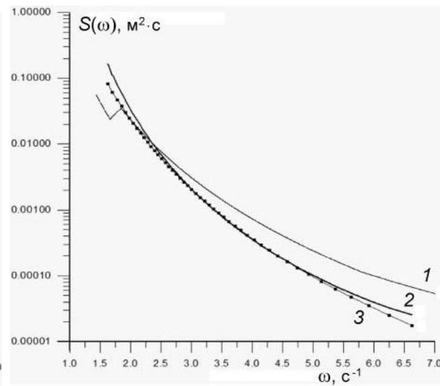
Рис. 8. Частотные спектры волнения.
