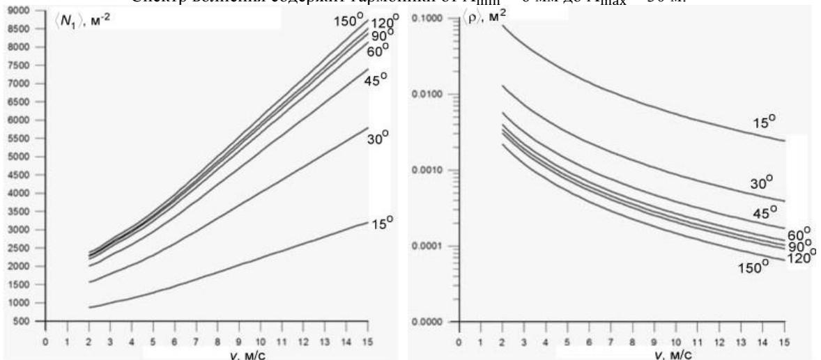
Рис. 4. Зависимости плотности числа зеркальных точек  $\langle N_1 \rangle$  и величины  $\langle \rho \rangle$  от скорости ветра  $v$ , рассчитанные по формулам из [3], при различной ширине углового распределения энергии гармоник  $\Delta\theta$ . Спектр волнения содержит гармоники от  $\Lambda_{\min} = 6$  мм до  $\Lambda_{\max} = 30$  м.
