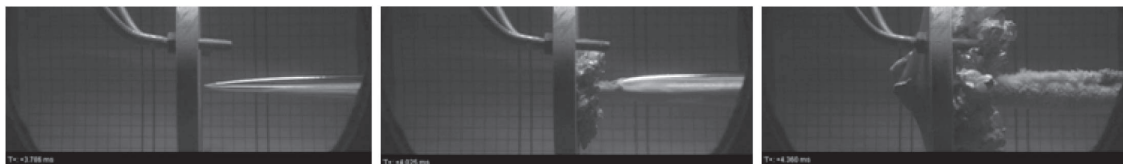
Рис. 5. Фоторегистрограмма взаимодействия суперкавитирующего реактивного снаряда в воде с дюралюминиевой преградой толщиной 16 мм при V = 494 м/с.
