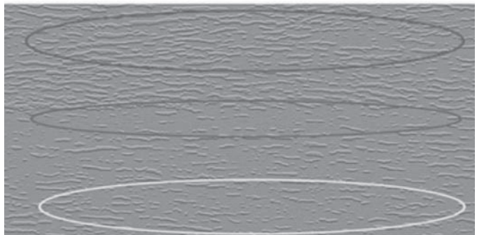
Рис. 5. Результат сегментирования изображения турбулентного следа и области сегментирования.
