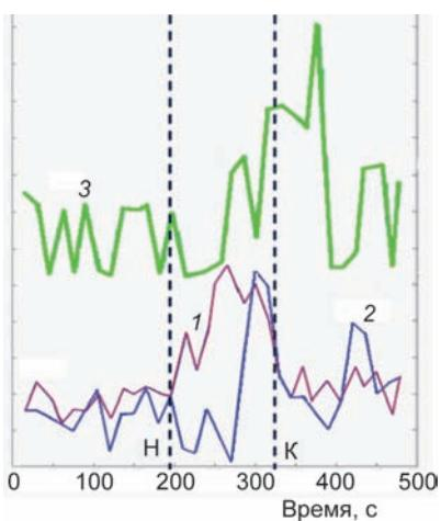
Рис. 8. Результаты обработки сигналов СЛЛ (1), ФЯМ (2) и АЛ (3) при пересечении собственного следа судна-постановщика с возрастом 20 мин.
