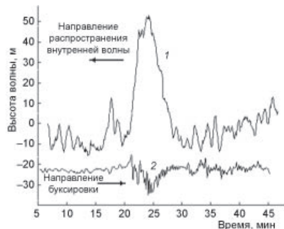
Рис. 2. Воздействие уединенной волны на заглубитель: случай, когда направление буксировки противоположно направлению распространения внутренней волны. 1 — профиль внутренней волны; 2 — запись вертикальных смещений заглубителя. «0» вертикальной оси соответствует средней точке участка термоклина, охватываемого распределенным датчиком в начальной точке разреза при встрече с волновым образованием. Запись вертикальных смещений заглубителя на всех рисунках смещена относительно «0» шкалы для удобства изображения.
