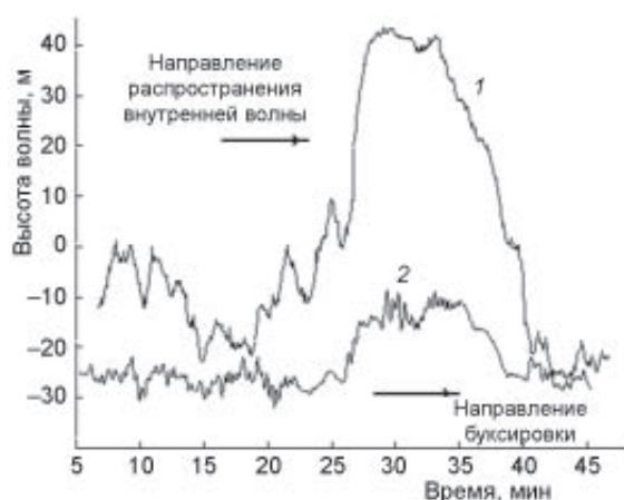
Рис. 3. Воздействие уединенной волны на заглубитель: случай, когда направление буксировки совпадает с направлением распространения внутренней волны.
