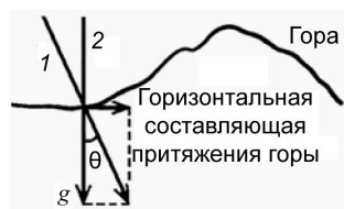
Рис. 1. Угол \theta , характеризующий отклонение отвесной линии, обусловленное притяжением горы. 1 — линия отвеса при наличии горы; 2 — линия отвеса при отсутствии горы [4].
