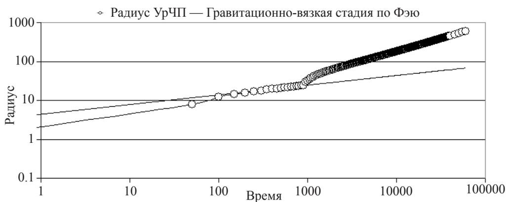
Рис. 5. Сравнение численного решения полной задачи, полученного на основе УрЧП с формулой Фэя для гравитационно-вязкой стадии.
