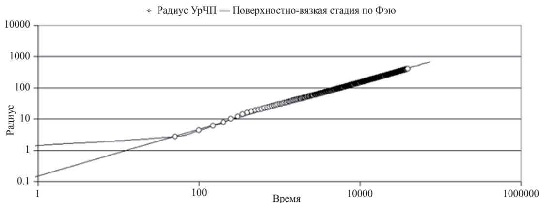
Рис. 3. Сравнение численного решения, полученного на основе УрЧП без учета силы гравитации с формулой Фэя для поверхностно-вязкой стадии.
